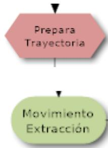
La trayectoria de aproximación del robot al piso está determinada, en primera instancia, por la identificación del mismo y su asociación con el modelo CAD correspondiente (ver epígrafe 2.2 *Generación de Trayectorias*)
