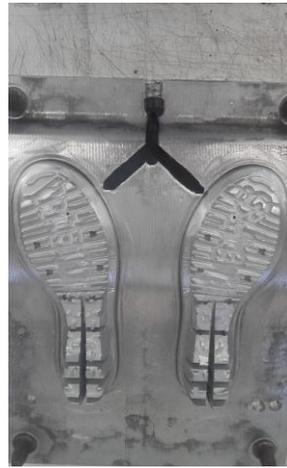
Figura 4: Extracción del piso desde posición vertical y detalle de la mazarota en la posición horizontal
