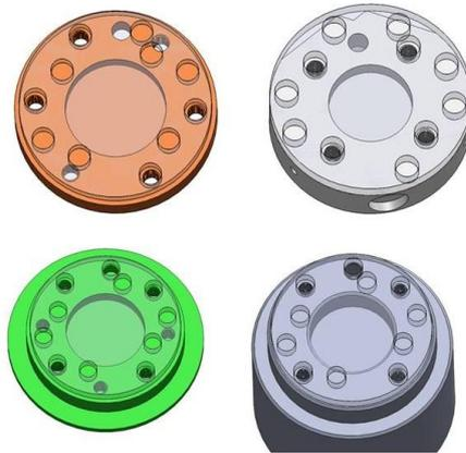
Figura 12: Ejemplos de acoplamientos válidos para diferentes robots (ABB, UR, COMAU)
